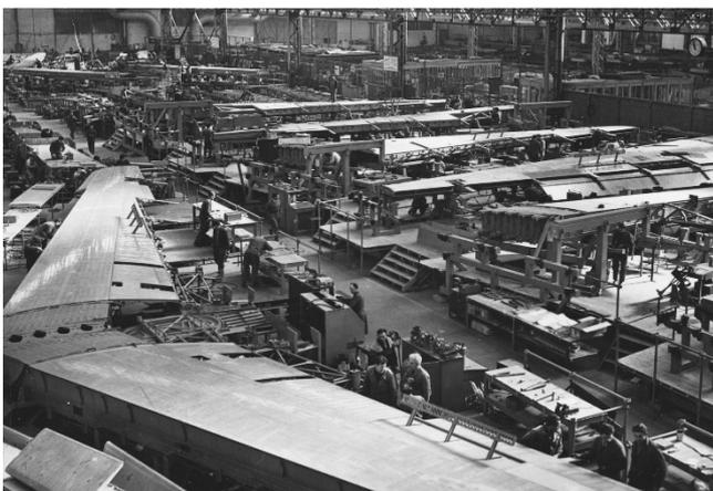
Fabrication des voilures de *Caravelle* dans l'usine Sud-aviation de Bouguenais, sans date. (coll. UD CFDT)
